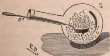
Fig. 79. — Préparation primitive de l'acide sulfurique par le nitre et le soufre, suivant le procédé de Nicolas Lefèvre.
